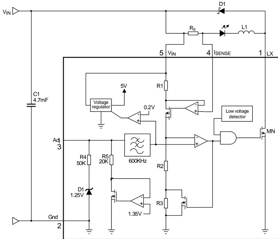
**Figure 1. Block Diagram**
